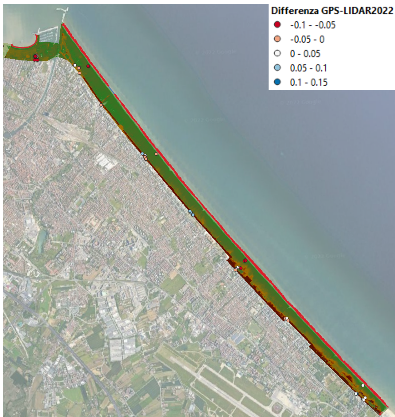
Figura 7 distribuzione dei punti di controllo e andamento delle differenze quota GPS-Lidar2022- Rimini Sud
