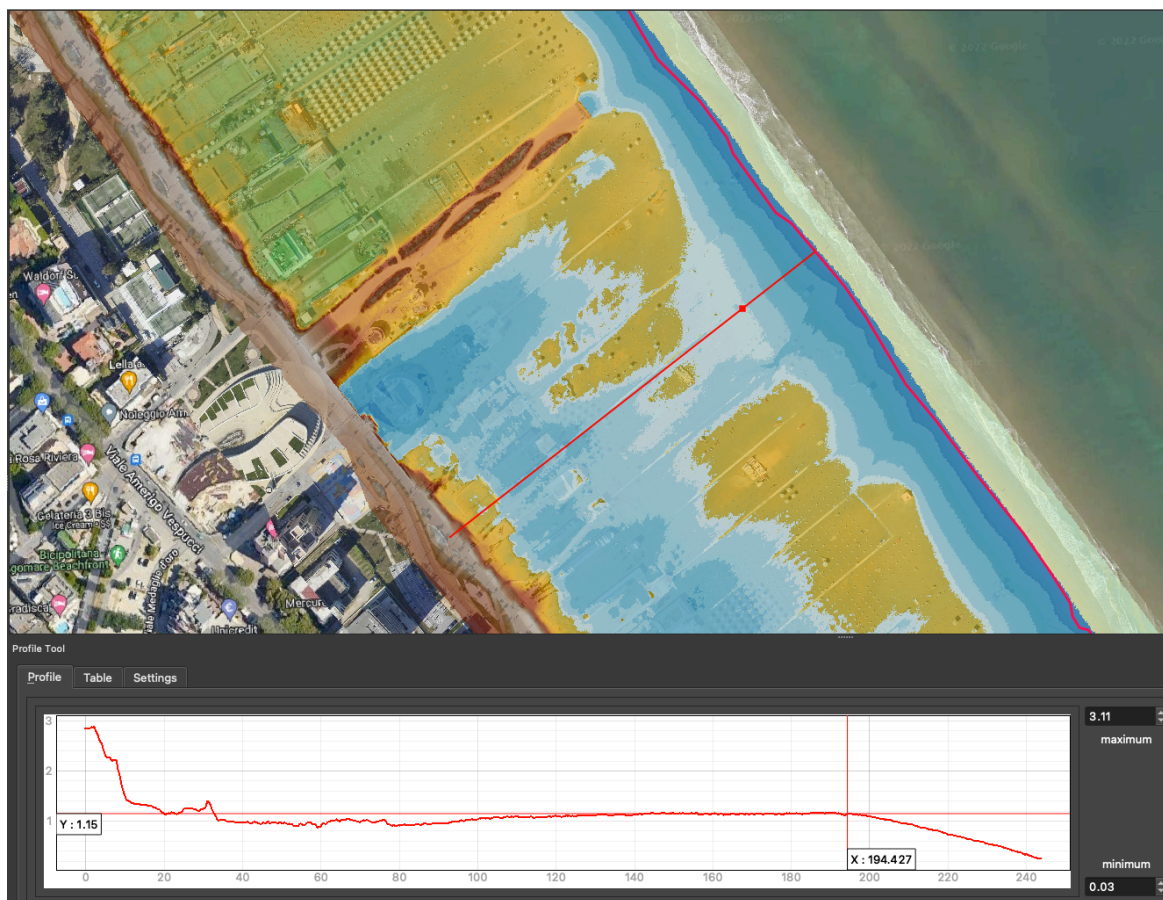
Figura 13 transetto topografico derivato da Lidar - Bagno 30 Rimini Sud – Allagamento con evento di TR = 1 anno
