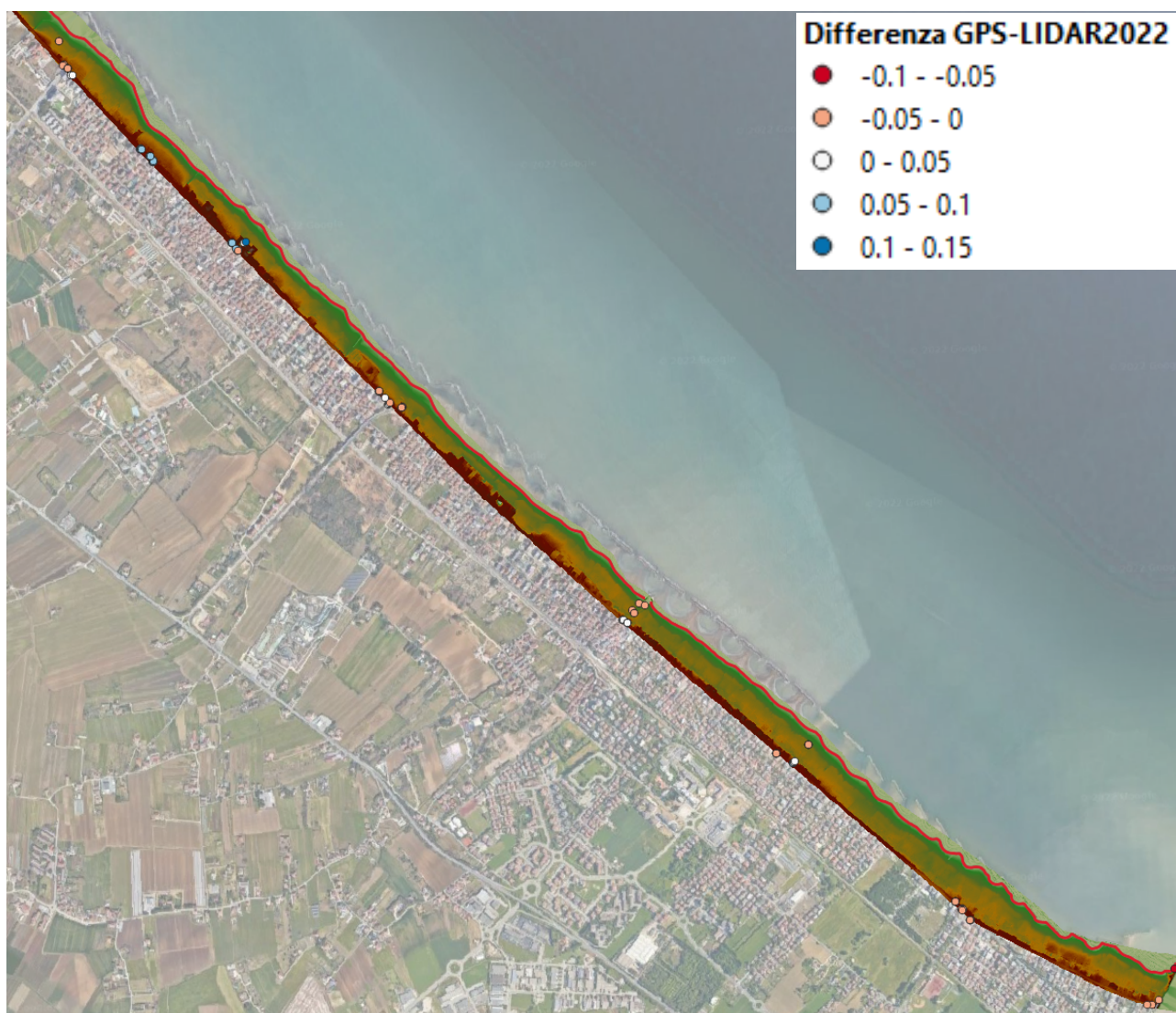
Figura 6 distribuzione dei punti di controllo e andamento delle differenze quota GPS-Lidar2022- Rimini Nord
