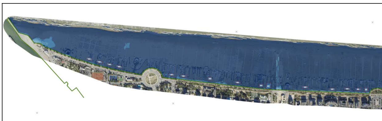
Figura 4 - Particolare della mappa allagamento relativo alle aree di Rimini Sud nel caso di realizzazione delle barriere continue fino alla quota di 2,85 m s.l.m. (scenario post-operam dell'evento con RT=100 anni proiettato al 2100).
