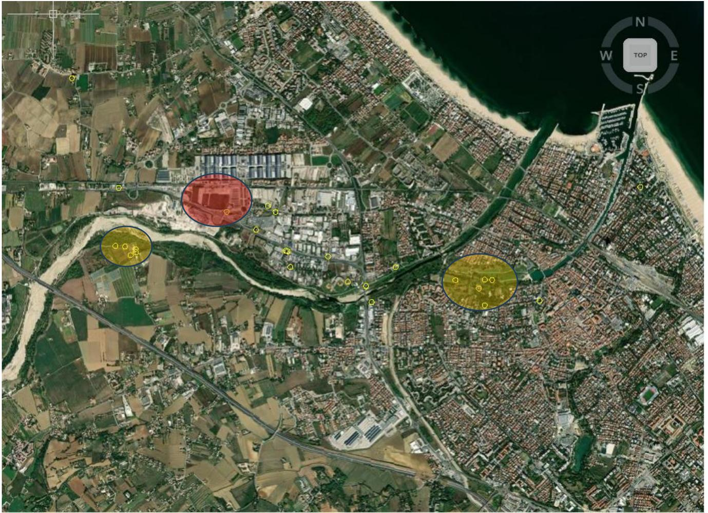
fig. 3-27 Captazioni filtranti parzialmente o completamente nella prima falda confinata. Con evidenza campo pozzi polveriera e campo pozzi parco Marecchia e area di interesse.
