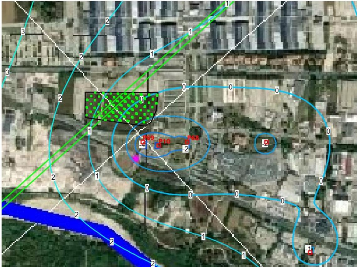
fig. 4-35 Forward particle tracking dal parcheggio. Vista planimetrica a 365gg nella simulazione Stress-Falda minima
