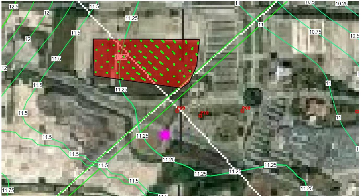
**fig. 4-24 Vista planimetrica delle particelle rilasciate nell'area parcheggio a 1 anno. (isopieze strato aquitard1).**
