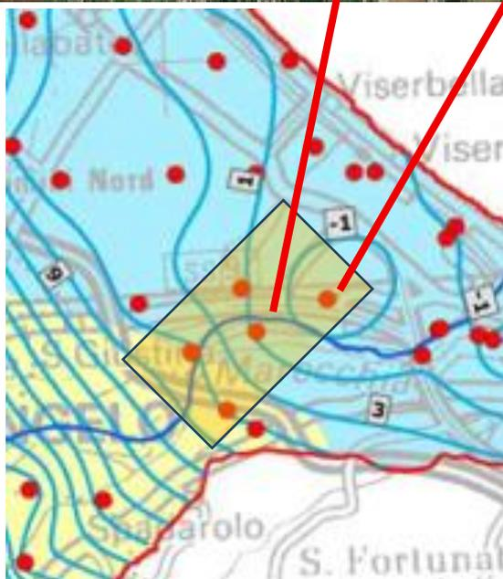
fig. 4-29 Andamento piezometrico falda confinata per la condizione critica..
