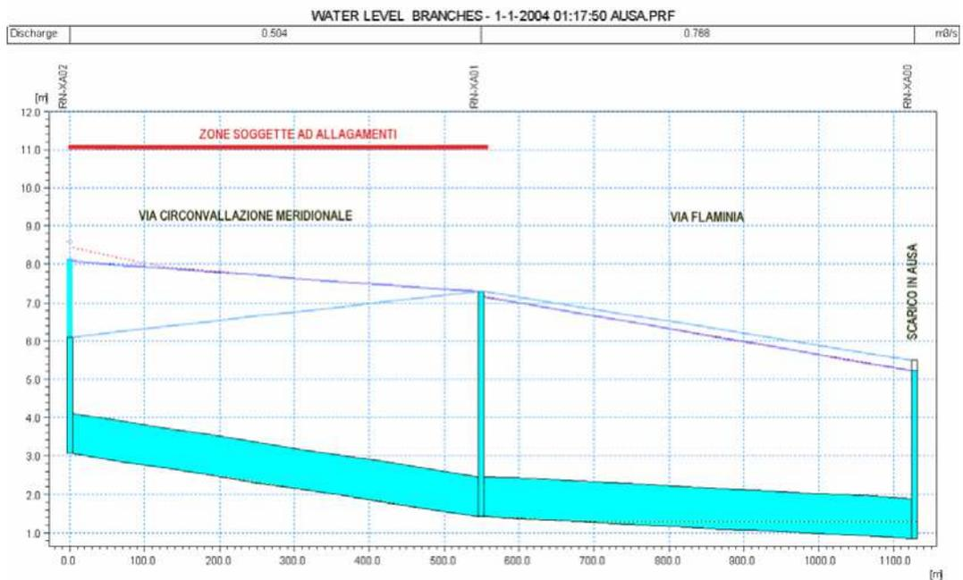
**Fig. 6.3.1.17 – Profilo longitudinale scolmatore Colonnella – collettore ovoidale. Stato attuale.**
