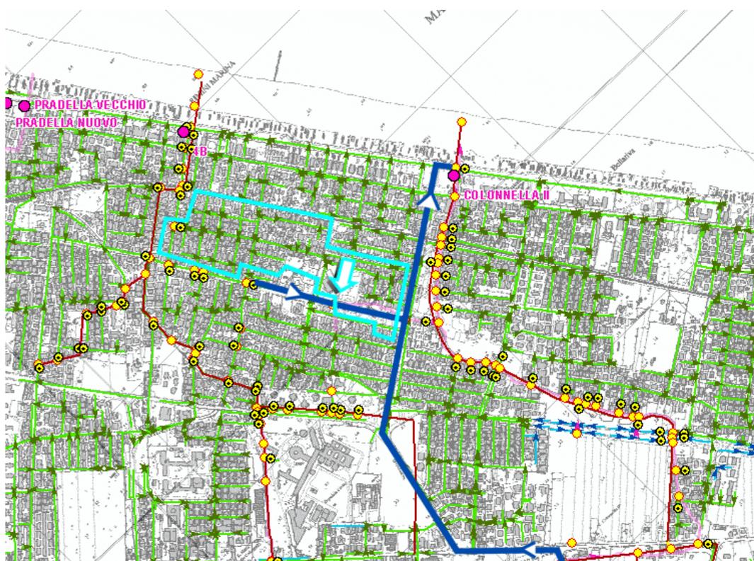
Figura 8.2.1.1 – Colonnella e Macanno. Schematizzazione degli scolmatore del Macanno e del Colonnella di progetto.
