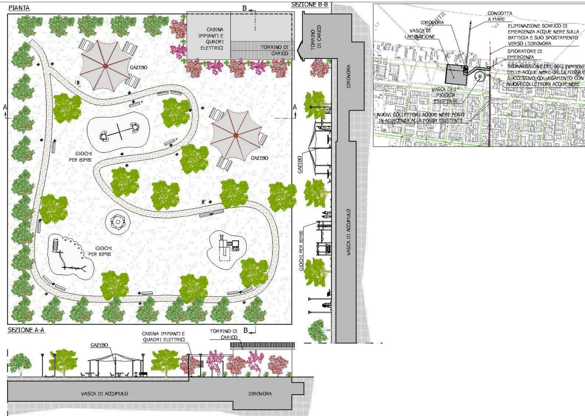
**Figura 7.2.3 – Esempio di opere di inserimento ambientale e mitigazione degli impatti per un impianto idrovoro dotato di vasca di accumulo**
