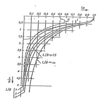
lp è un coefficiente adimensionale, funzione della forma della fondazione e del rapporto z/B tra la profondità z e la più piccola dimensione trasversale B della superficie di carico. Nel diagramma vengono forniti i valori di Ip nei casi di:
