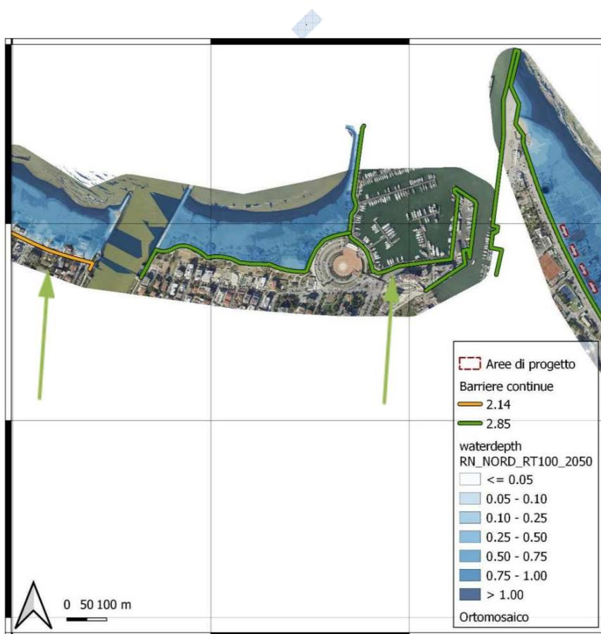
Figura 4.1.4 - Particolare della mappa allagamento nel caso di realizzazione delle barriere continue.
