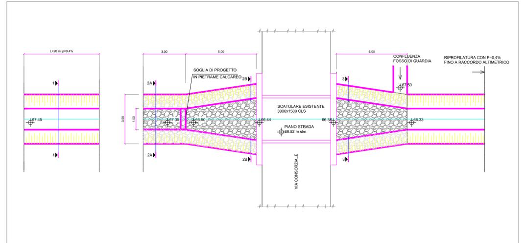
Profilo longitudinale stato di progetto - scala 1:100
