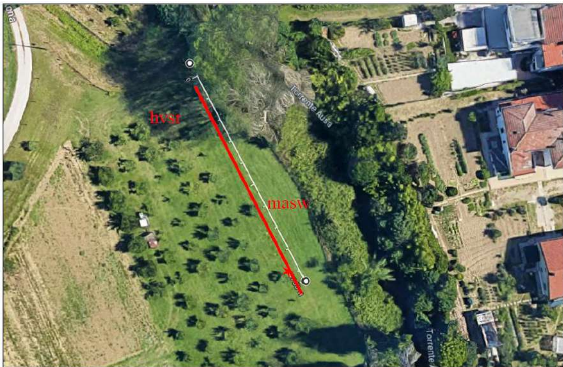
Figura 29 – Individuazione delle indagini geofisiche eseguite in corrispondenza dell'area oggetto di intervento (in sinistra idrografica): rilievo sismico passivo a stazione singola HVSR e rilievo sismico attivo con stendimento MASW.
