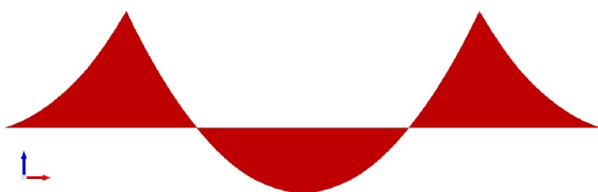
Figura 122 – Involuppo delle sollecitazioni flessionali per combinazioni di carico SLU e SLV [daNm] relative agli elementi di acciaio dell'impalcato. Si può notare come la collocazione delle cerniere lungo le travate principali (selle Gerber) sia tale da condurre ad uno schema di travata continua a tre campate. In altre parole, le cerniere sono posizionate in prossimità delle sezioni in corrispondenza delle quali, nel caso di perfetta continuità delle travate, si verificherebbe l'annullamento delle sollecitazioni flessionali.
