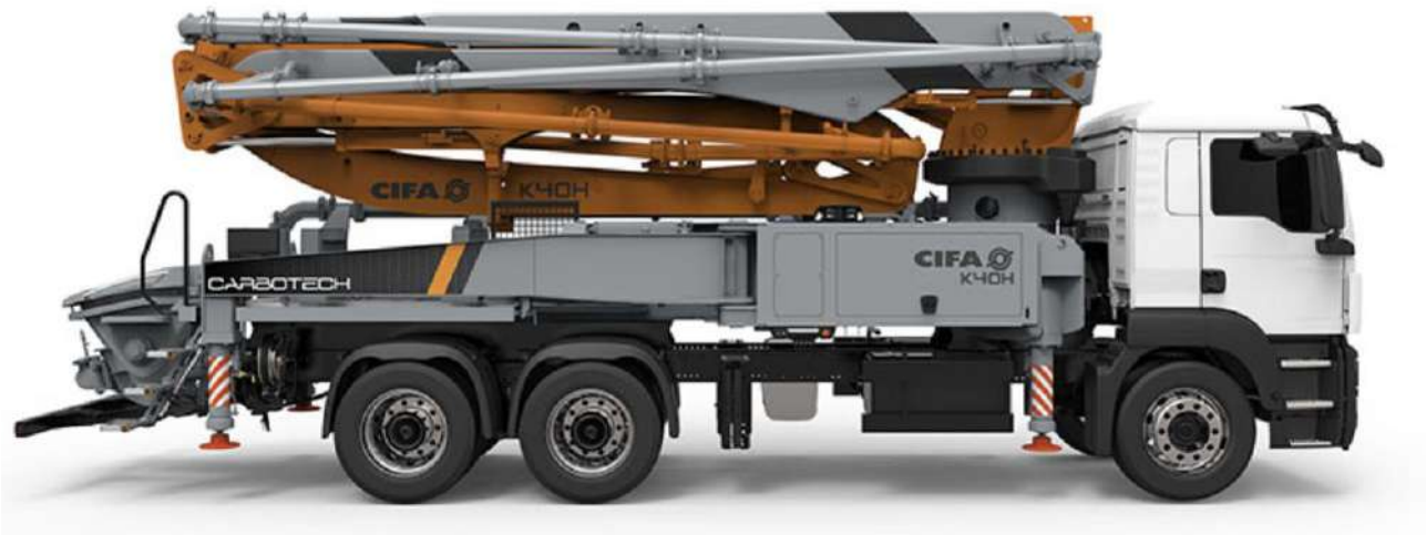
Figura 134 – Pompa autocarrata per getti di calcestruzzo con braccio da 40 m.
