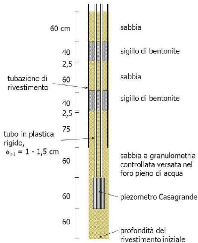
Figura 32 – Piezometro di Casagrande.
