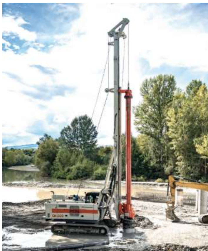
Figura 137 – Esempio di macchina perforatrice (fonte: COMACCHIO S.p.A.).
