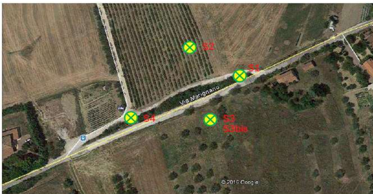
Figura 31 – Punti di indagine relativi i sondaggi a distruzione di nucleo e installazione delle celle piezometriche di Casagrande da parte della Soil Investigation S.n.c. Di Marco Rossi & C..
