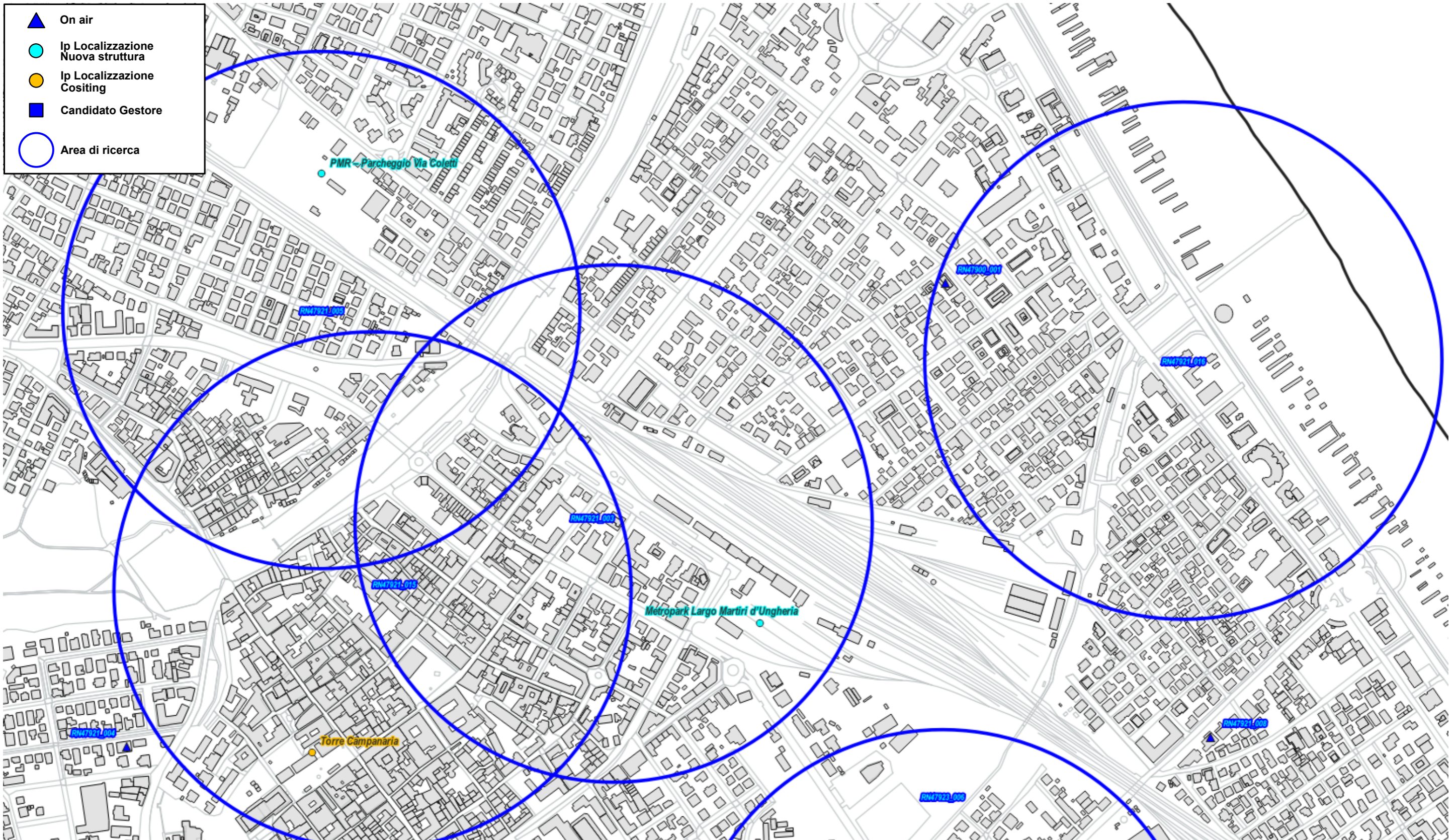
Fig. 49 Dettaglio piano di rete – Gestore ILIAD
