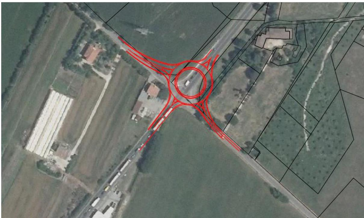
Il progetto di fattibilità tecnico economica – definitivo prevede l'eliminazione dell'attuale incrocio semaforizzato e la realizzazione di una nuova intersezione a rotatoria con diametro di 50 m. L'intervento prevede:
