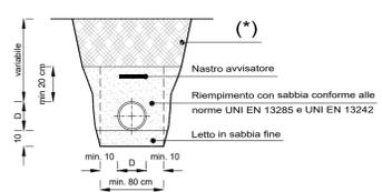
Sezioni tipo per condotti posati ad una profondita' inferiore a m 1.00
