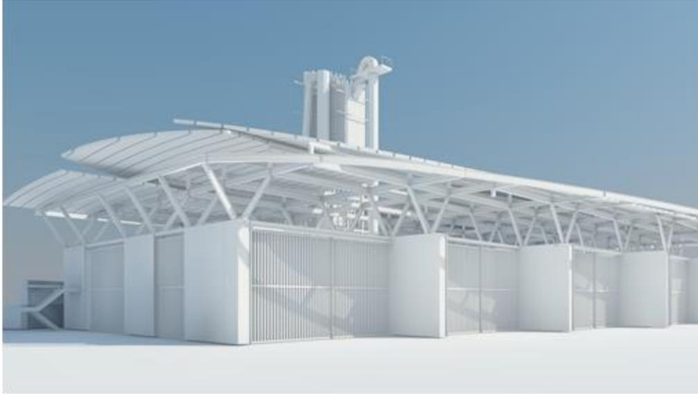
Il sistema strutturale fondazioni e pilastri e travi reticolari e spaziali in acciaio e la copertura integrata da pannelli fotovoltaici restano invariati.
