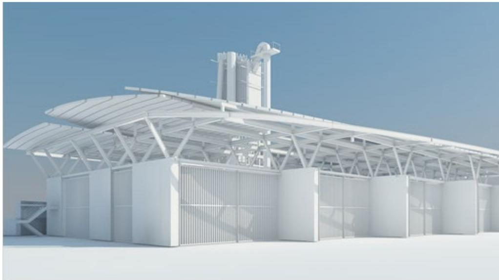
Il sistema strutturale fondazioni e pilastri e travi reticolari e spaziali in acciaio e la copertura integrata da pannelli fotovoltaici restano invariati.
