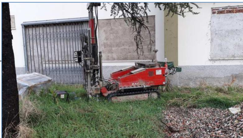
Fig. 4.1 Mezzo con cui è stata realizzata la prova penetrometrica
