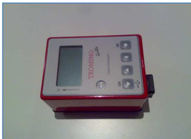
Fig. 4.2 Attrezzatura utilizzata per l'indagine sismica
