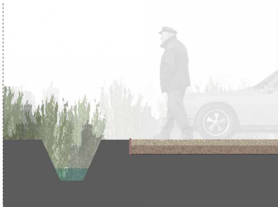
parcheggio e fosso di scolo
